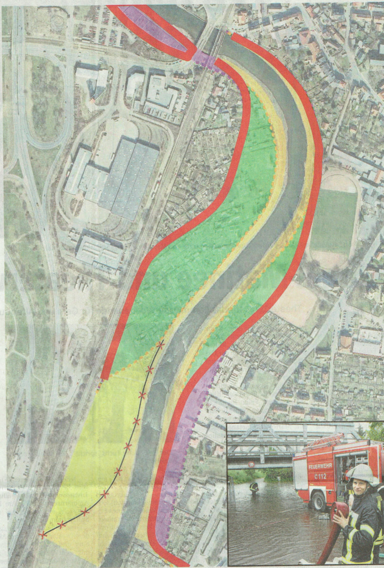
Die roten Linien zeigen den geplanten Hochwasserkorridor. Die verschiedenen Farben stehen für einzelne Varianten, die nun zu einer kombiniert wurden. Die Zwötzener Brücke im Norden – rechts der dortige Feuerwehreinsatz zum Hochwasser 2013 – soll nicht verändert werden.
